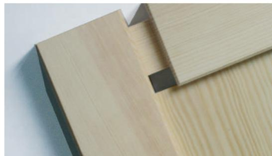
Assemblage par tenon et mortaise
